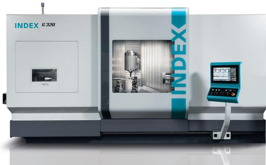
1 Das Drehfräszentrum G320 bietet eine maximale Drehlänge von 1400 mm und ermöglicht vollwertiges 5-Achs-Fräsen © Index-Werke
